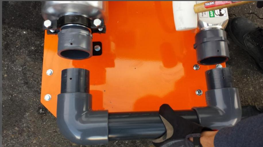
Retire las ocho (8) tuercas, reemplace los elementos, y proceda a reinstalar el equipo
